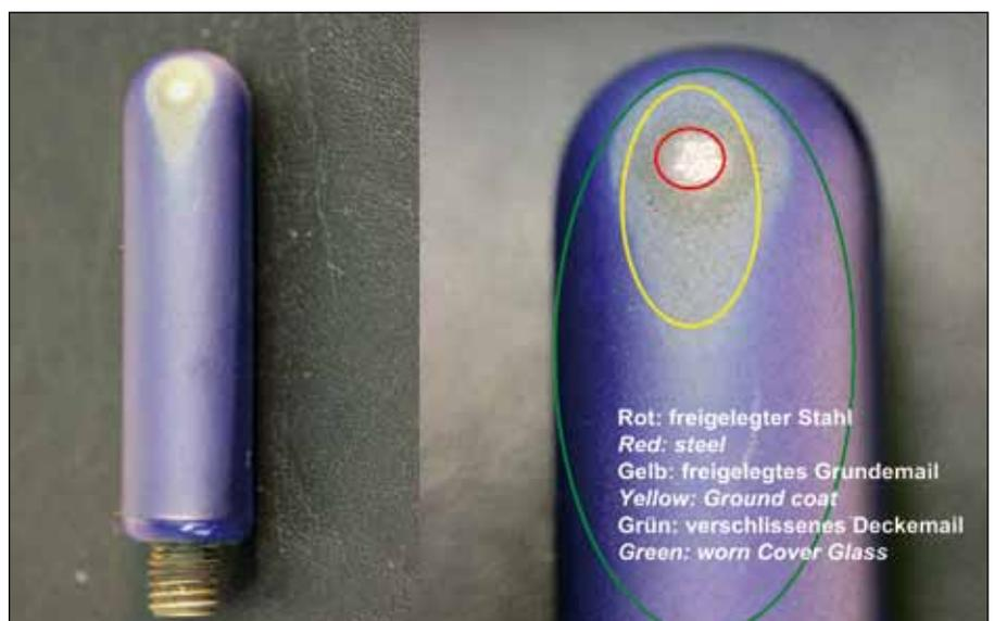
**Abbildung 5:** Verschlossene, angeströmte Seite des einen Probekörpers mit inhomogenem Emailabtrag. Der größte Emailabtrag findet am Beginn der Kuppe des Probekörpers statt.
