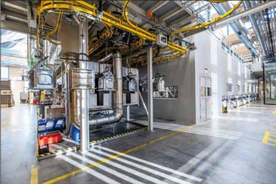
Die 5-Zonen Spritzvorbehandlungsanlage entfernt alle Verunreinigungen der mechanischen Fertigung.
