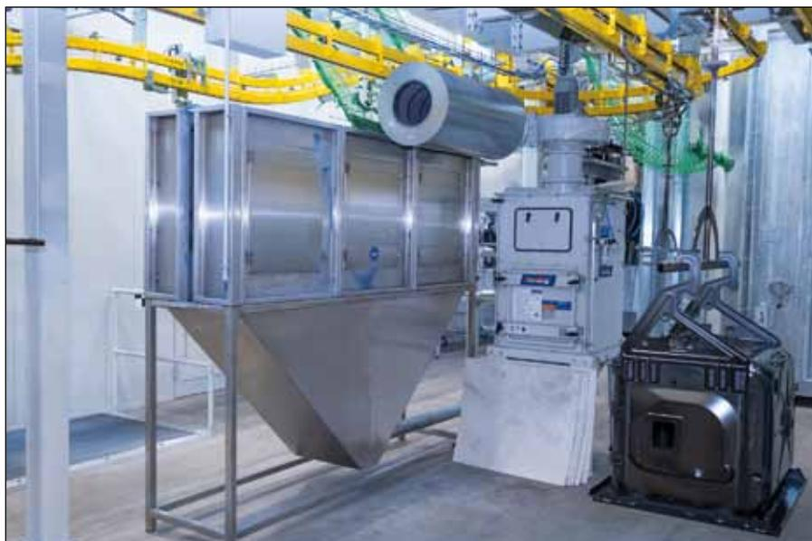
Durch die automatische Reinigung der Gehänge entfallen Sortierfunktionen und es kann mit einem einheitlichen Gehänge gearbeitet werden.
