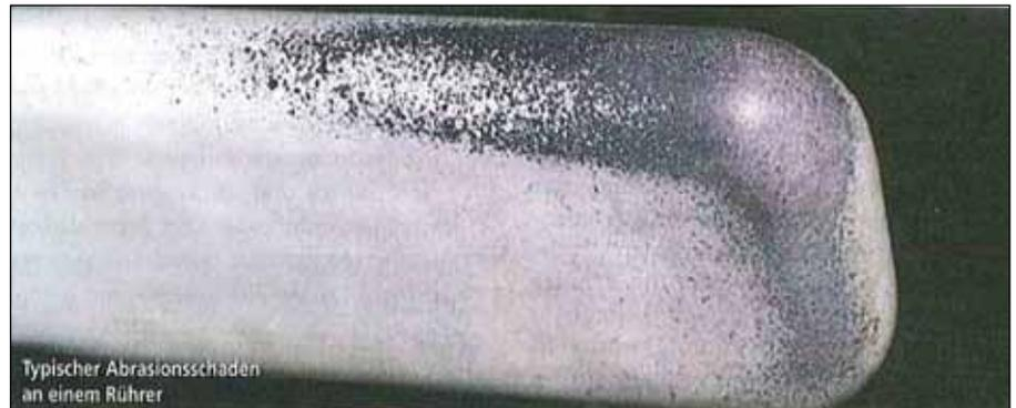
Abbildung 3: Verschleißschaden an einem emaillierten Rührorgan /5/
