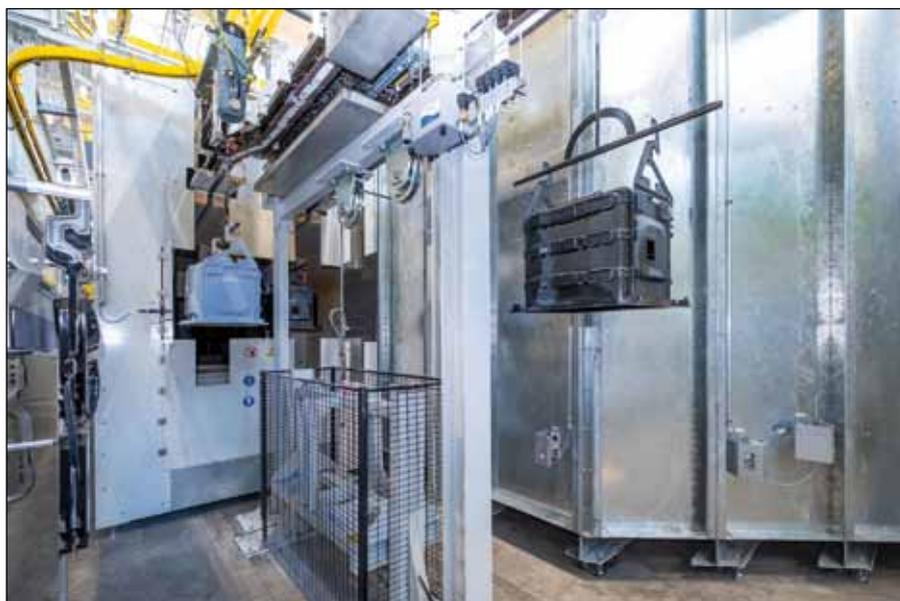
Im Einbrennofen werden die Werkstücke auf einen Schuppenblechförderer übergeben.
