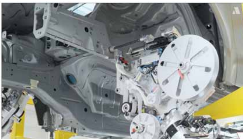
Patch Sealing System zum Korrosionsschutz von Sportwagen
