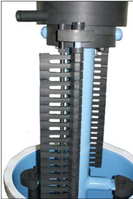
Abbildung 8: Dünnschichtverdampfer in Technischem Email; gezeigt ist der Einbau des Wischersystems aus elektrisch leitfähigem PTFE
