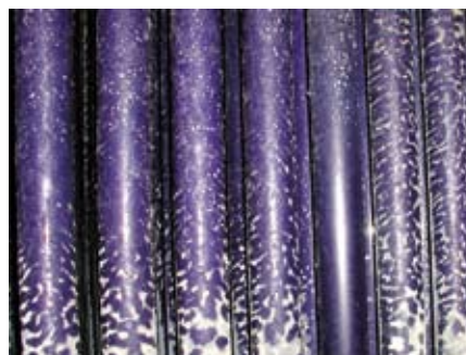
Bild 5: Technisches Email als optimales Beschichtungssystem für die Rohrbündel eines Wärmeaustauschers in einer Hausmüllverbrennungsanlage
