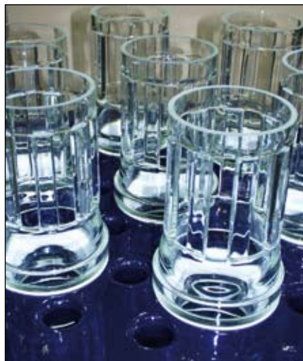
Bild 5: Glaskamine auf dem emaillierten Lochboden
