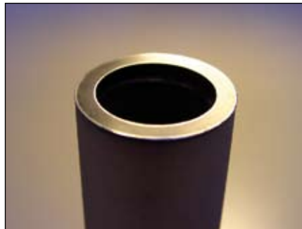
Bild 3: Stirnseitig emaillierte Nabe (Durchmesser ca. 30 mm), feingeschliffen und poliert als Funktionsmuster für eine axiale Wellendichtung
