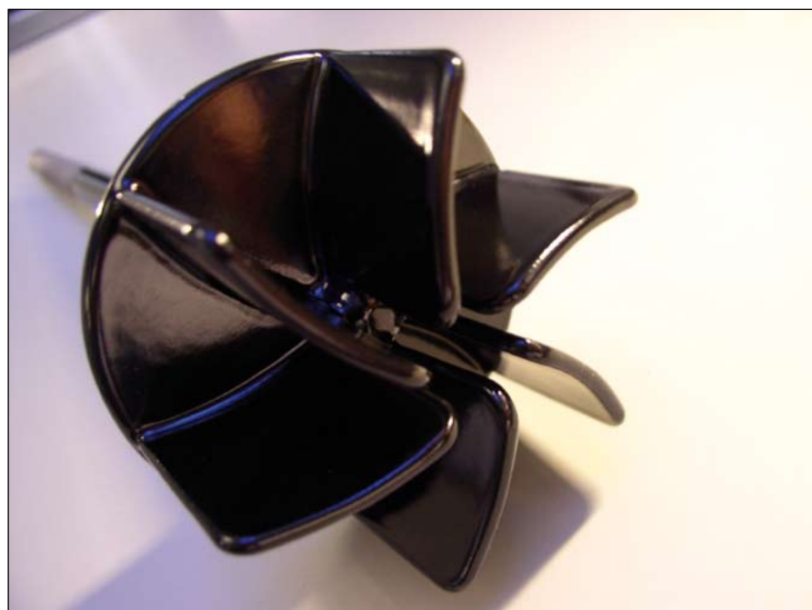
Bild 2: Laufrad einer Radialpumpe für den Einsatz in einer Wellenlötanlage, Durchmesser ca. 80 mm
