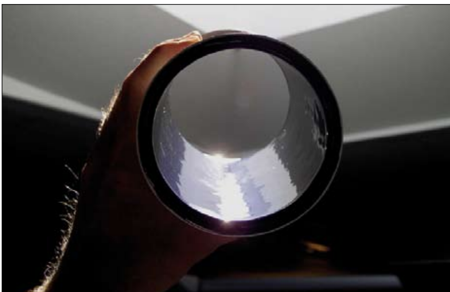
Abb. 1: Technisches Email – extrem glatte Oberflächenbeschaffenheit in Verbindung mit hohem Verschleißwiderstand gegen abrasiv wirkende Medien und hoher Korrosionsresistenz. Visuelle Prüfung der Oberfläche im Gegenlicht.
