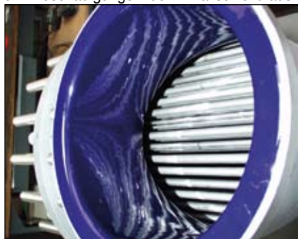
Bild 7: Wärmeübertrager: Email-Mantel mit Siliciumcarbid-Rohren
