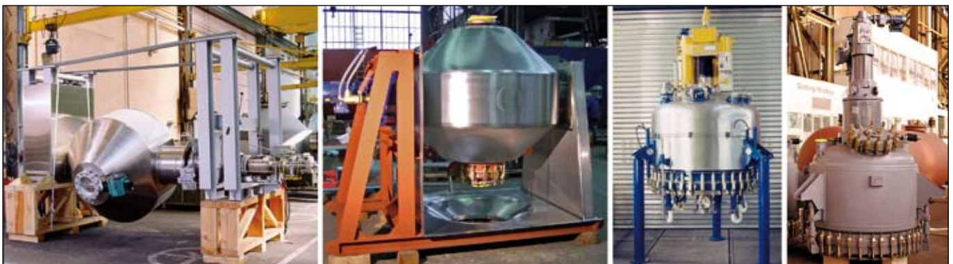
Abbildung 9: Doppelkonustrockner und Filtertrockner in Technischem Email, speziell für die Trocknung von Wirkstoffen in der pharmazeutischen Fertigung
