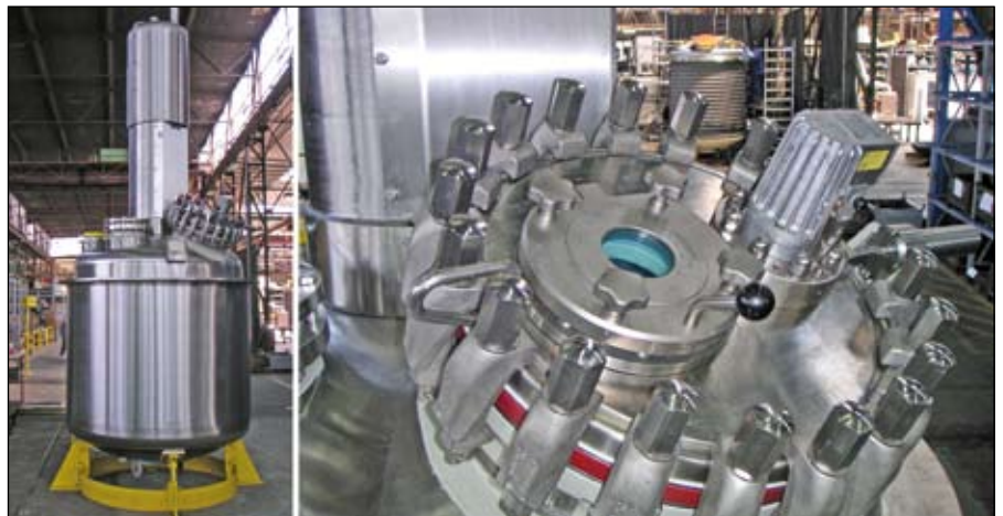
Abbildung 6: Voll isolierter Rührbehälter mit Einhausung des Antriebes sowie Mannlochdeckel aus emailliertem Edelstahl
