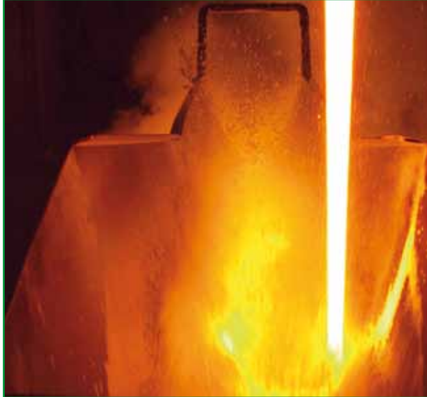
Ablassen der Emailschnmelze aus einem Trommelofen (oben) und Abschrecken in Wasser (unten) (Bilder: Wendel GmbH)
