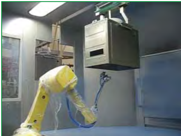
Roboterspritzen (Bild: E.I.C. Group Engineering Innovations Consulting GmbH)
