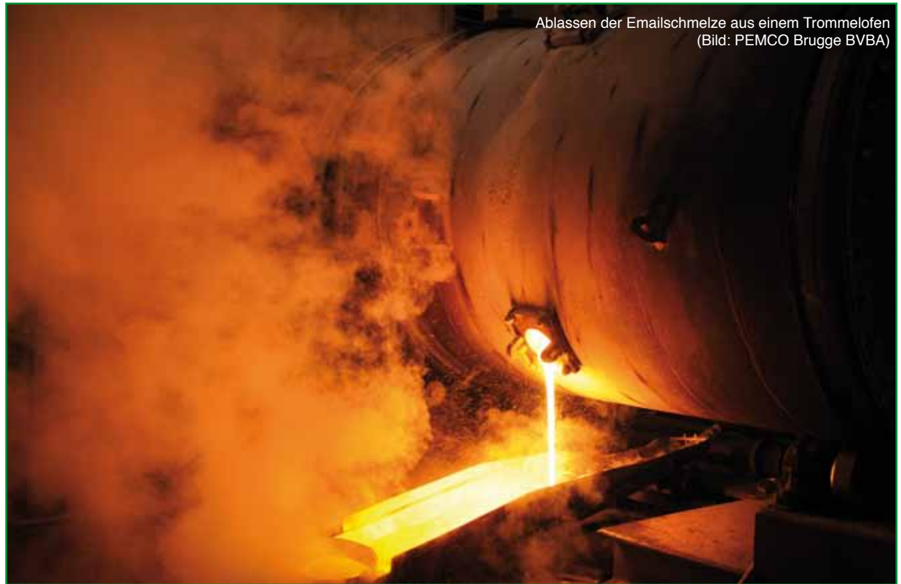
Ablassen der Emailschnmelze aus einem Trommelofen (oben) und Abschrecken in Wasser (unten) (Bilder: Wendel GmbH)
