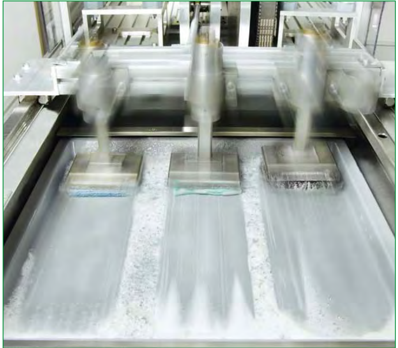
Dauerprüfung eines Backbleches mit verschiedenen Reinigungsmedien (Bild: Miele & Cie. KG)
