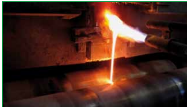
Abschrecken der kontinuierlich erschmolzenen Emailschmelze zwischen Kühlwalzen (Bild: Ferro (Holland) B.V.)
