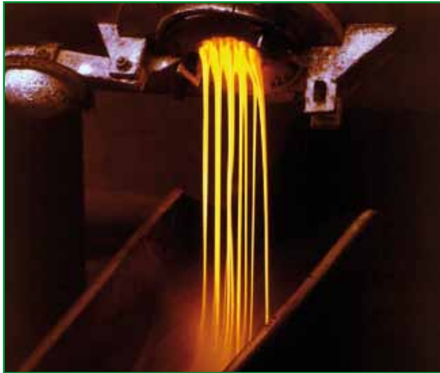
Ablassen der Emailschnmelze aus einem Trommelofen (oben) und Abschrecken in Wasser (unten) (Bilder: Wendel GmbH)
