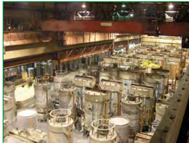
Haubenglühe (Bild: ThyssenKrupp Steel Europe AG)
