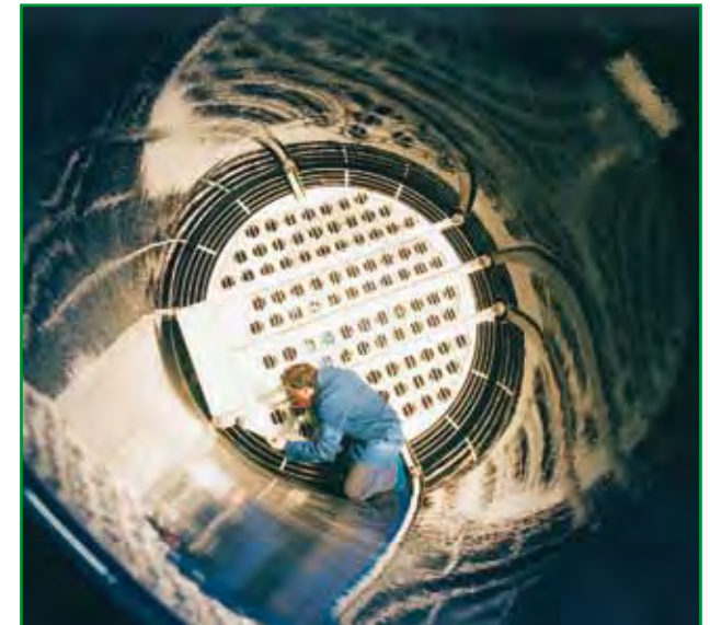
Qualitätsprüfung der Innenmaillierung eines Großbehälters (Bilder oben und unten: Pfaudler Werke GmbH)
