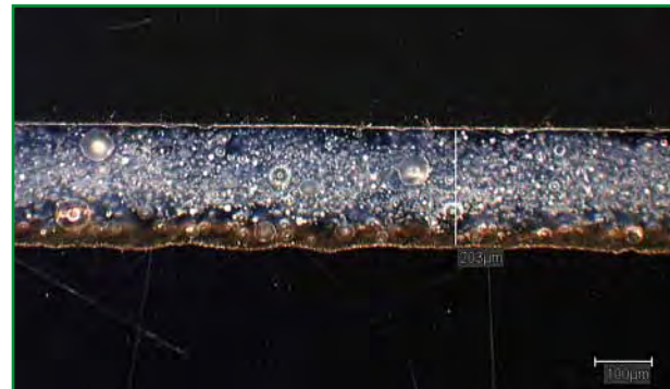
Schliff durch eine Direktemailierung (Bild: PEMCO Brugge BVBA)
