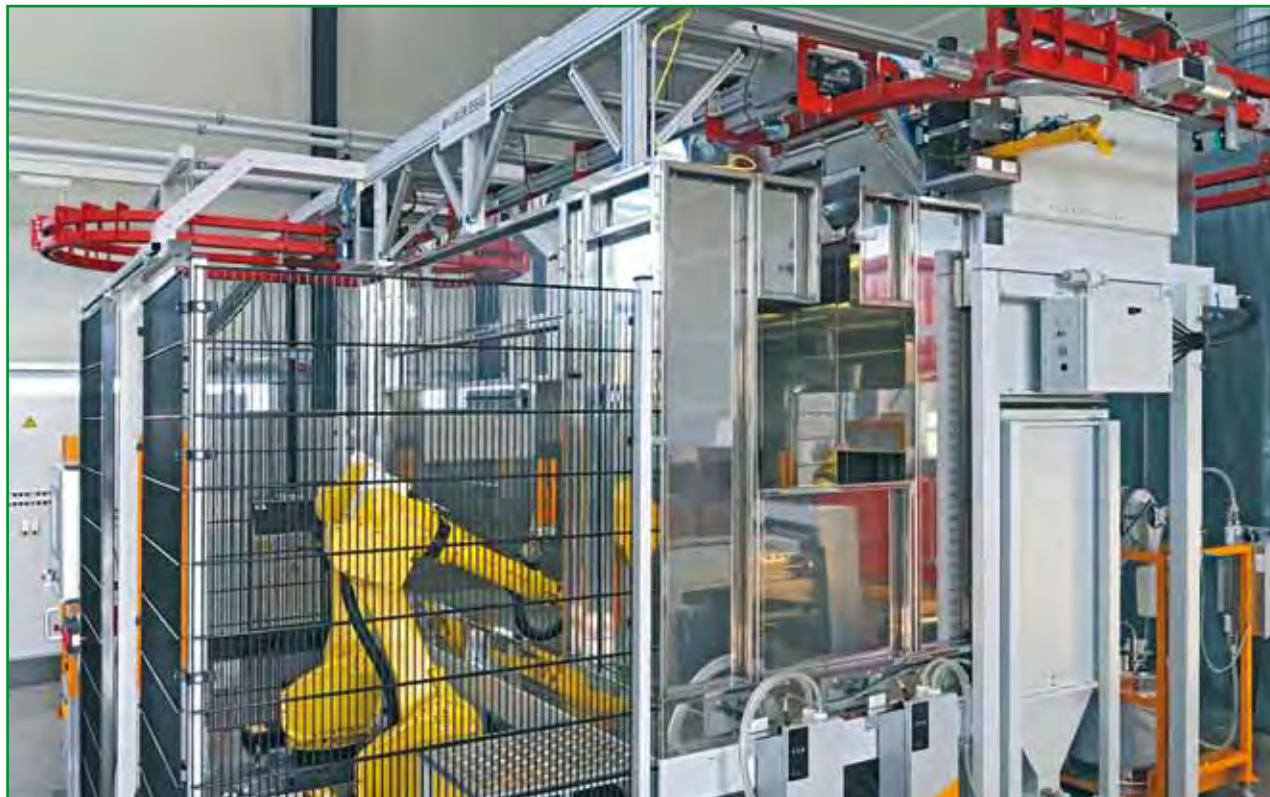
Pulverbeschichtungskabine mit Roboter und Pulverapplikation (Bild: KÜBLER ESSIG Maschinenbau GmbH)
