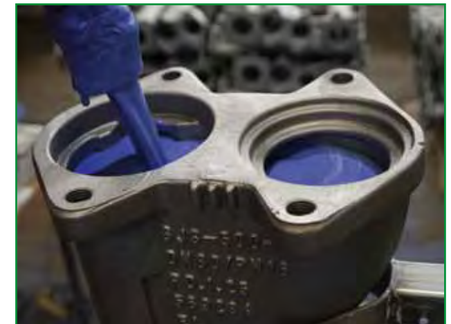
Manuelles Innen-Fluten (Bild unten rechts: EMK Email-, Metall- und Kunststoffverarbeitung GmbH)
