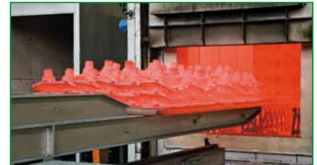
Ofenausfahrt von Multimediaschiebern (Bild: ERHARD GmbH & Co. KG)
