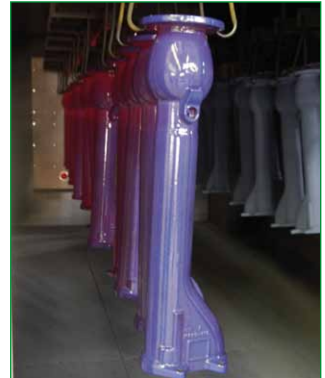
Aus- bzw. Einfahrt in einen Umkehröfen (Bild: EMK GmbH)
