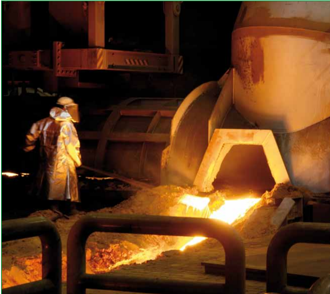
Hochofenabstich (Bild: ThyssenKrupp Steel Europe AG)
