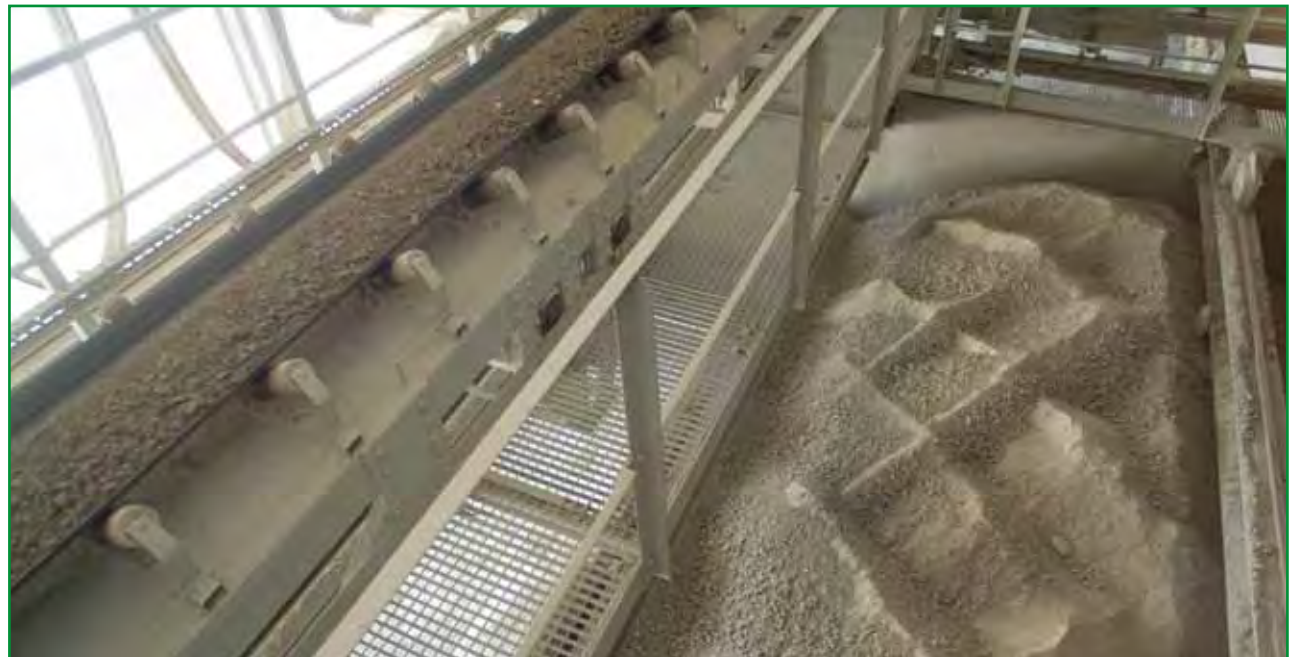
Mischwerk Sandborn: Homogenisierung eines Emailliertones (Bild: Stephan Schmidt Gruppe)
