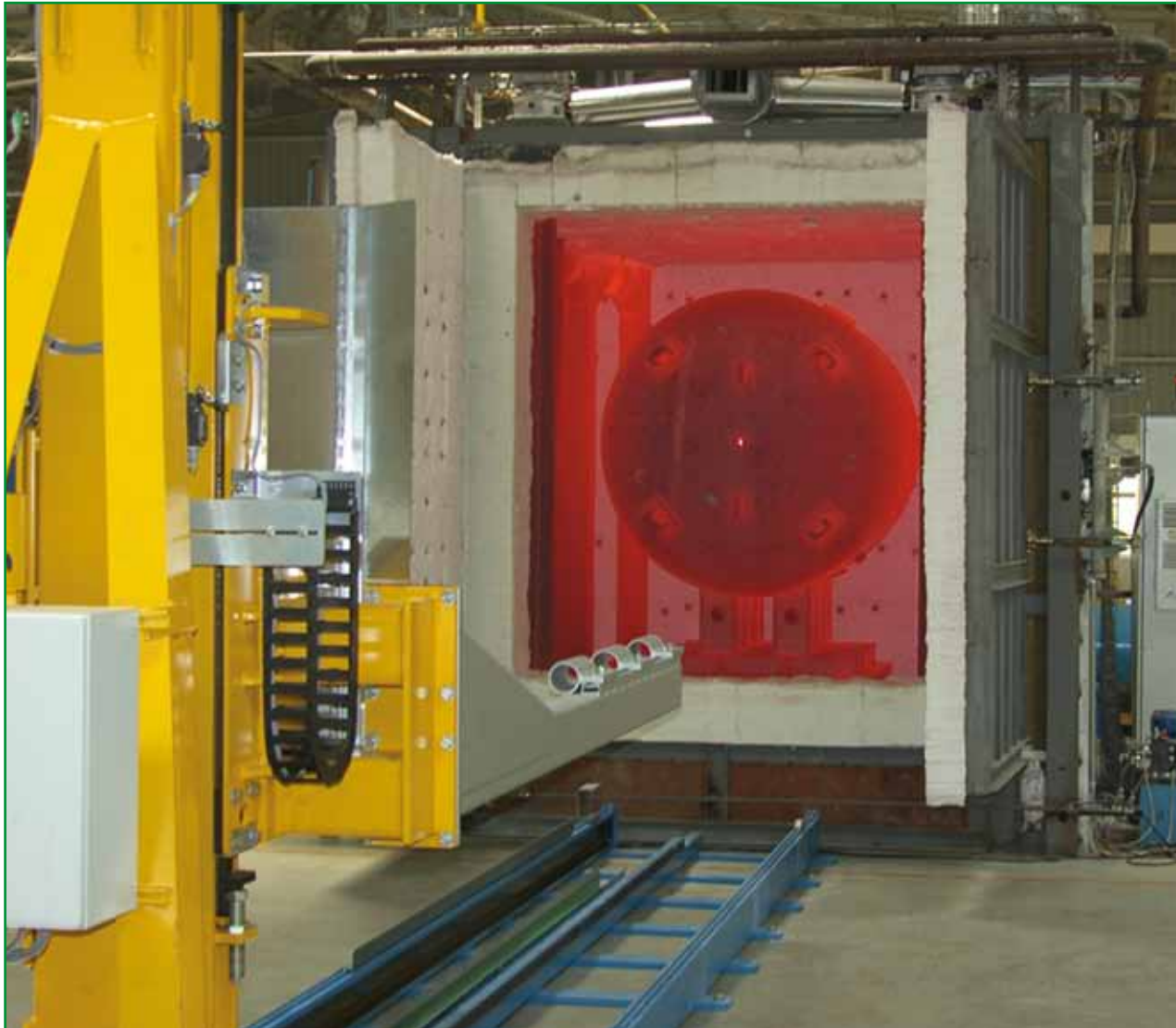
Kammerofen für Großbehälter (Bild unten rechts: E.I.C. Group Engineering Innovations Consulting GmbH)
