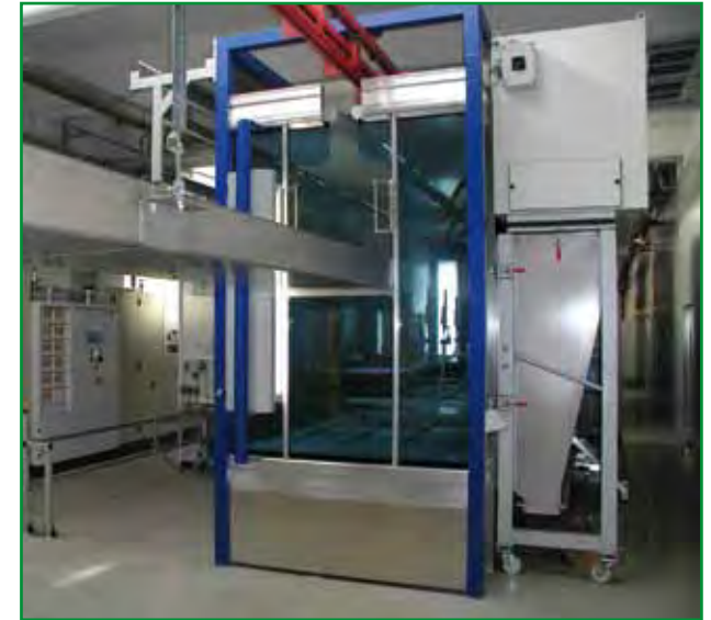
Pulverkabine (Bild: EISENMANN Anlagenbau GmbH & Co. KG)
